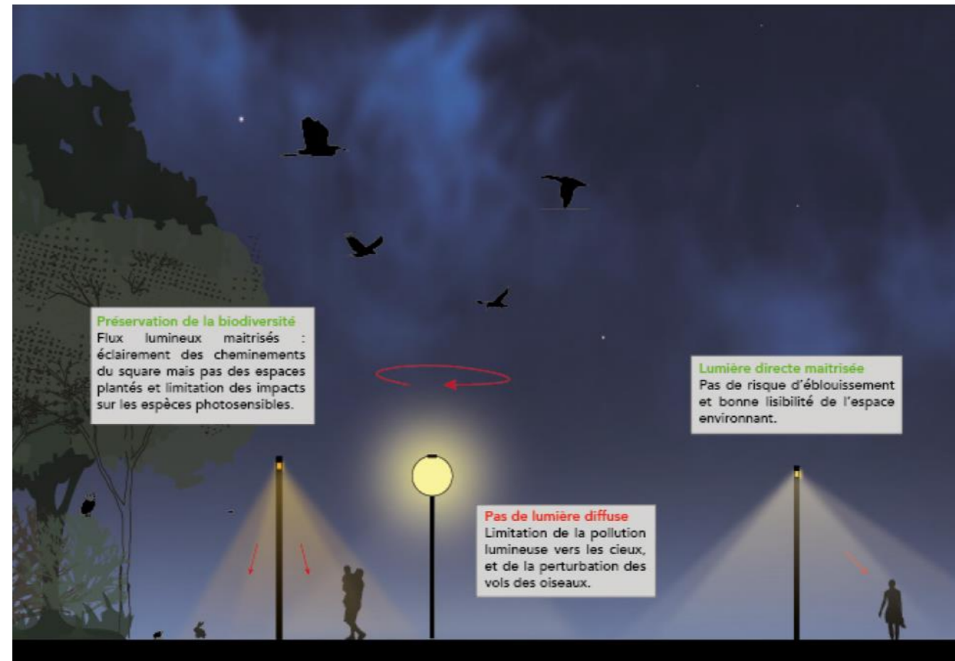
Figure 140 : Principe de réduction des impacts des émissions lumineuses (source : Notice PRO de l'éclairage du projet, On)
